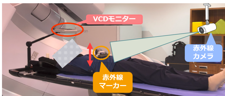
Fig.1 Respiratory Gating for Scanners (RGSC) システム
