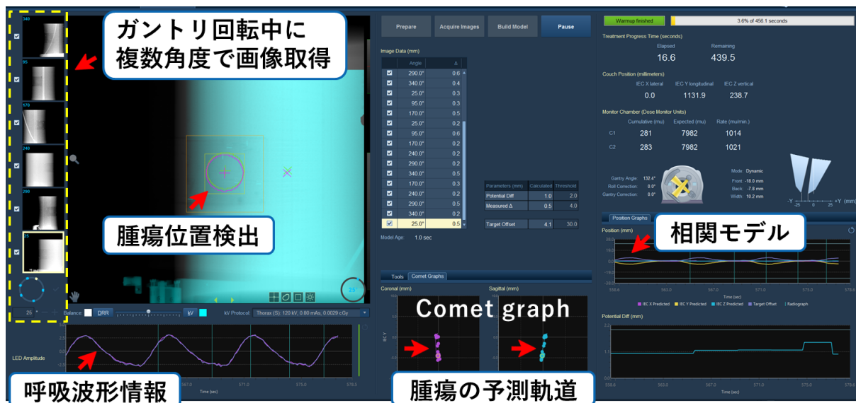
Fig. 8 Lung with Respiratory 追尾方法選択時の Radixact Synchrony 照射コンソール画面
