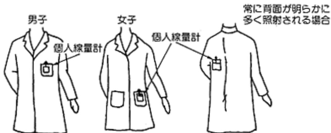
図1 体幹部均等被ばくの場合の線量計着用位置 1)
