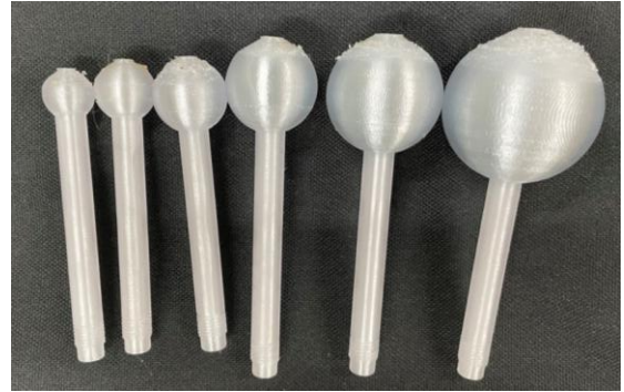
図1 NEMA ボディファントム用球体パーツ（10, 13, 17, 22, 28, 37mm φ）
