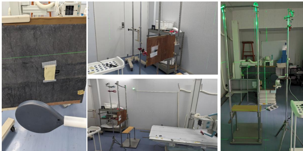
Fig. 1 逆ブロードビーム方法による防護資料測定の様子
