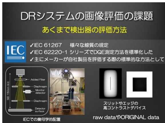
図1 DRシステム評価における幾何学的配置
