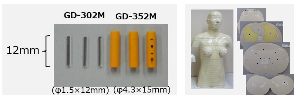
図6 ガラス線量計外観 (左), 人体ファントム外観 (右)
