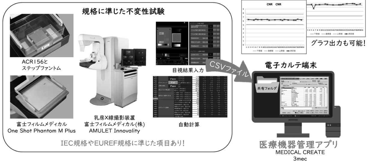
Fig. 3 乳房用 X 線撮影装置における不変性試験の DX 化
