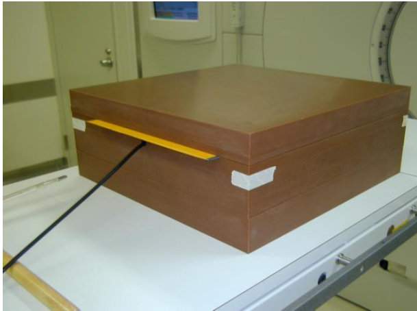
Fig. 4 人体等価個体ファントム中のフィルム配置例
