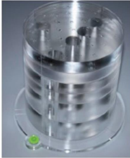
Fig. 1 The SEDENTEXCT dose index (DI) phantom 5)
